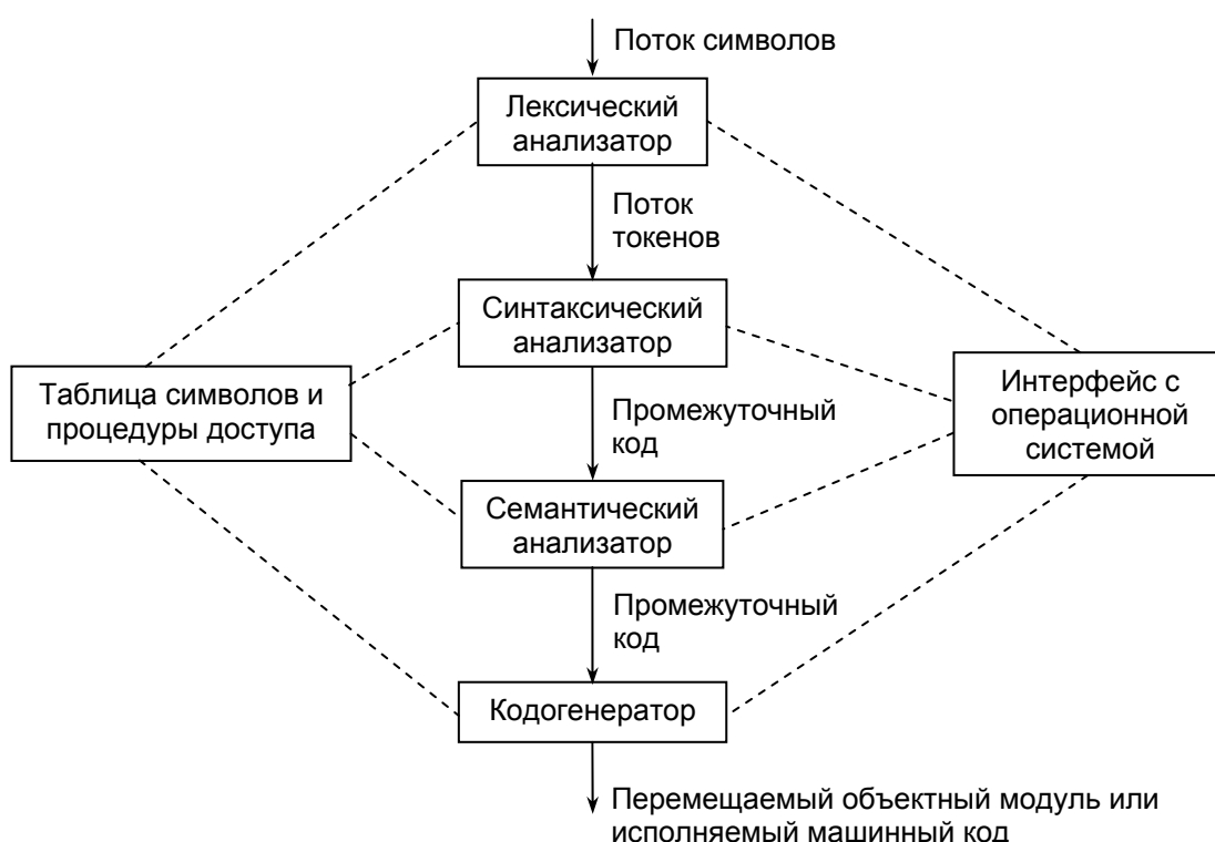
Рисунок 1. Общая структура простого (не оптимизирующего) компилятора
